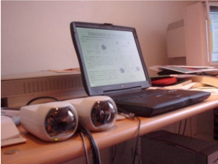
FIG. 8.14 – La plate-forme mobile : un ordinateur portable avec deux caméras EVI-G21
