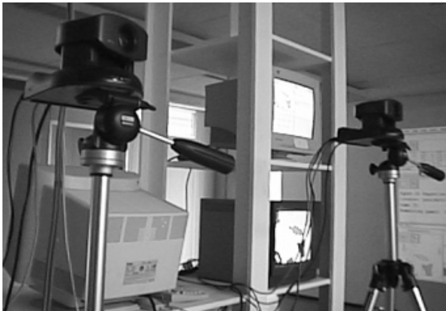
FIG. 8.1 – Dans chaque site, deux corps robotiques, constitués par deux caméras mobiles, sont placés devant un tableau blanc magnétique. (Site d'Anvers - Exposition LABORATORIUM).
